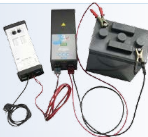
Hier ziet u hoe een typische opstelling eruit ziet. Op deze manier is het mogelijk om de batterij meerdere cycli na elkaar te ontladen en herladen.
