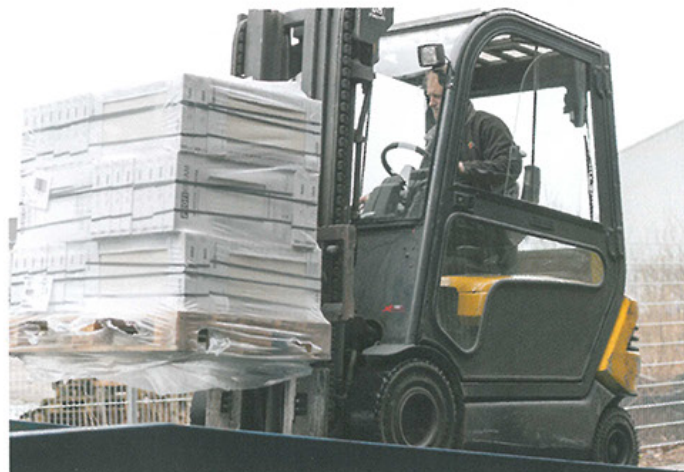
De heftrucks rijden de producten in de vrachtauto via een brug. Het oprijden kost veel energie.
