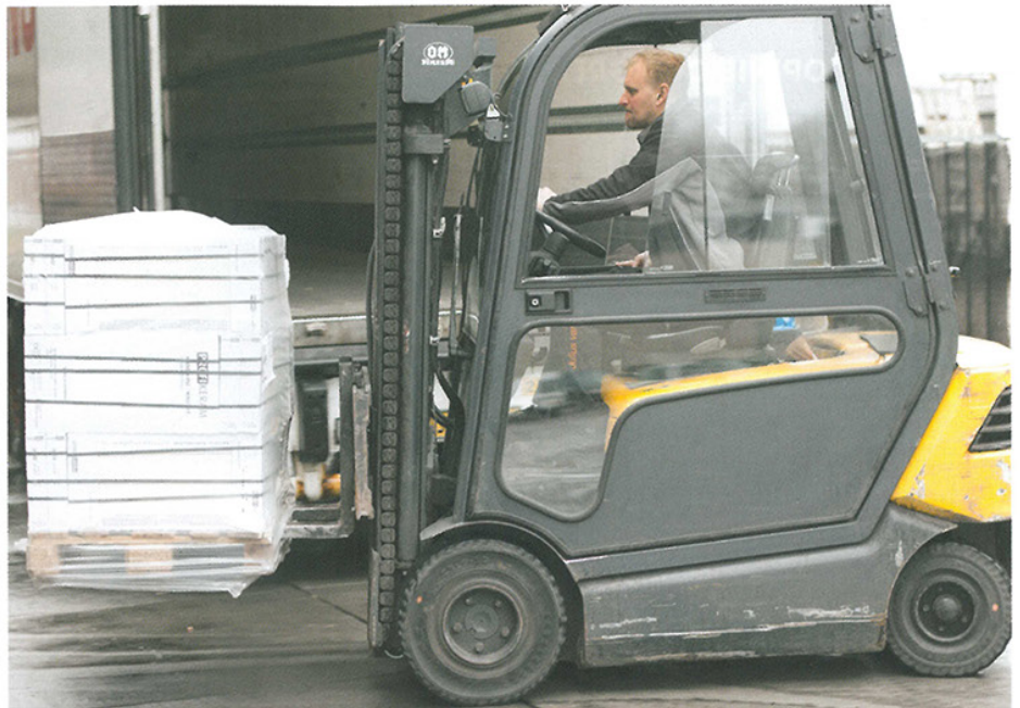
Het laden en lossen van vrachtauto's gaat de hele dag door. Deze heftrucks gebruiken veel energie en zijn voorzien van een zwaardere accu.
